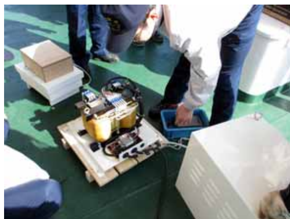
スコットトランスによる三相・単相変換
