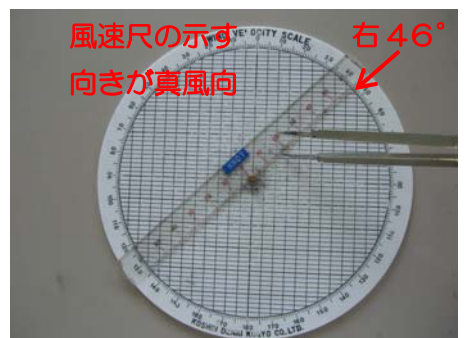
図13 真風向を読み (右 046° ) ジャイロ (船首方位) を加減する
